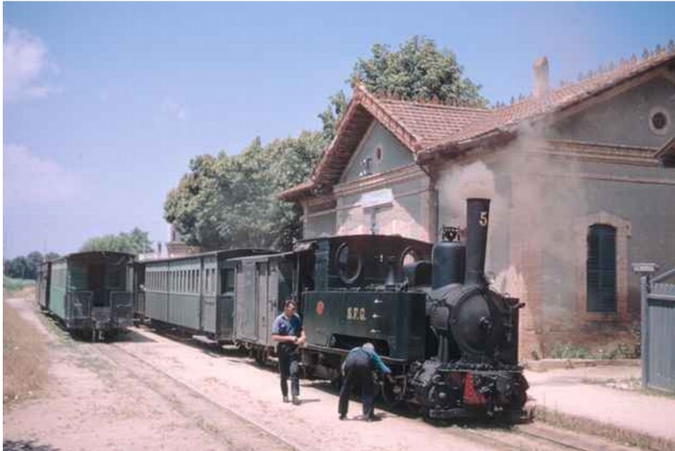
En Llagostera. Parada y revisión de rodamientos del bielaje. Foto copyright Les Dench, u n. l.
